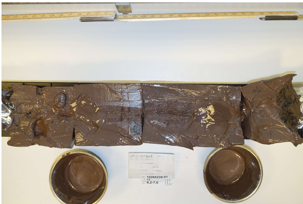
Figur 4-4: Prøve med kvikkleire fra borpunkt 13, dybde 6,2-7,0 m.
